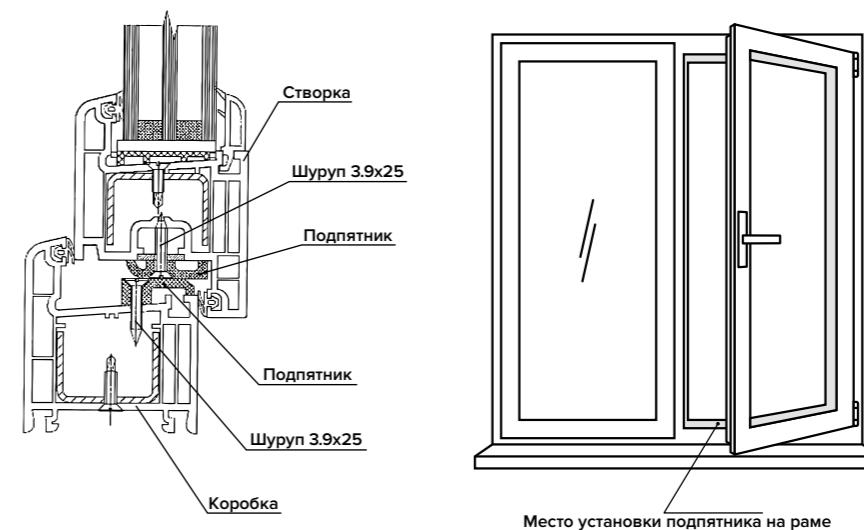
Оконные блоки из ПВХ-профиля оборудованы поворотно-откидным устройством с функцией щелевого проветривания, которое управляет единой ручкой.
